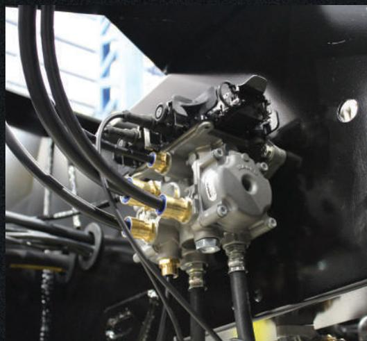
Sistema de frenagem totalmente integrado com 3ª via de emergência.
