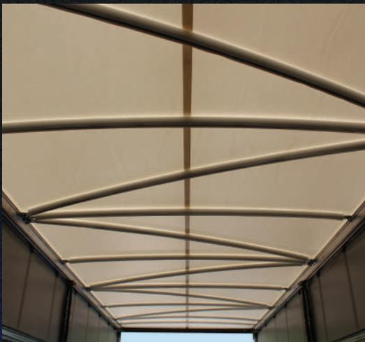
Teto treliçado com revestimento de espuma entre lona e varão.
