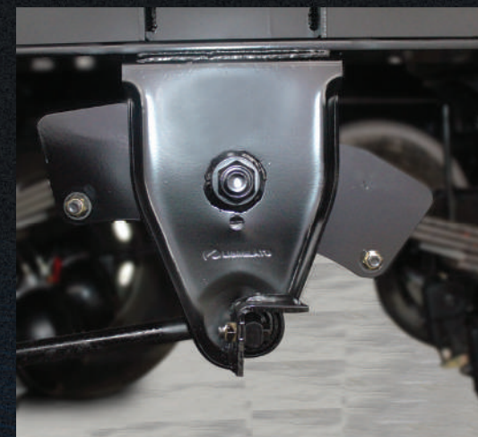
Balancim auto-lub. Não necessita de lubrificação.
