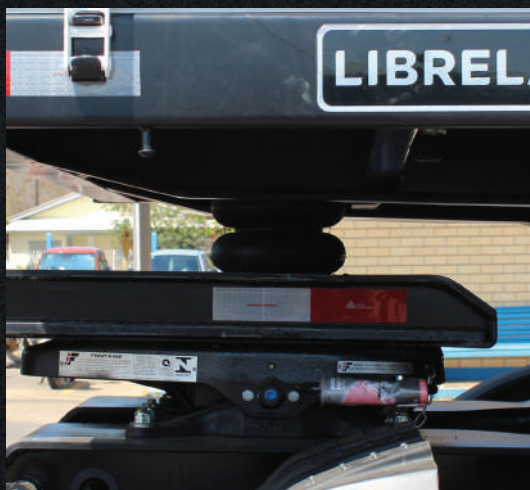
Sistema de pré-carga do acoplamento original de fábrica.
