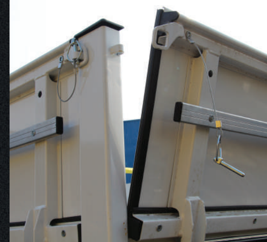
Vedação em todas as partes móveis da caixa de carga.
