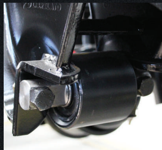
Buchas moleculares do braço tensor. Não desalinha.
